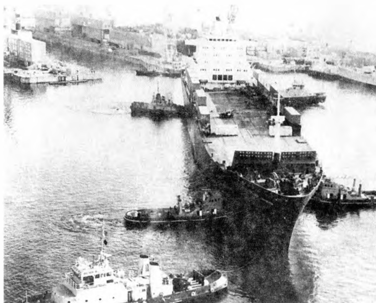
«Атлантик Конвейер» после переоборудования. За стенкой из контейнеров скрывается полетная палуба.
